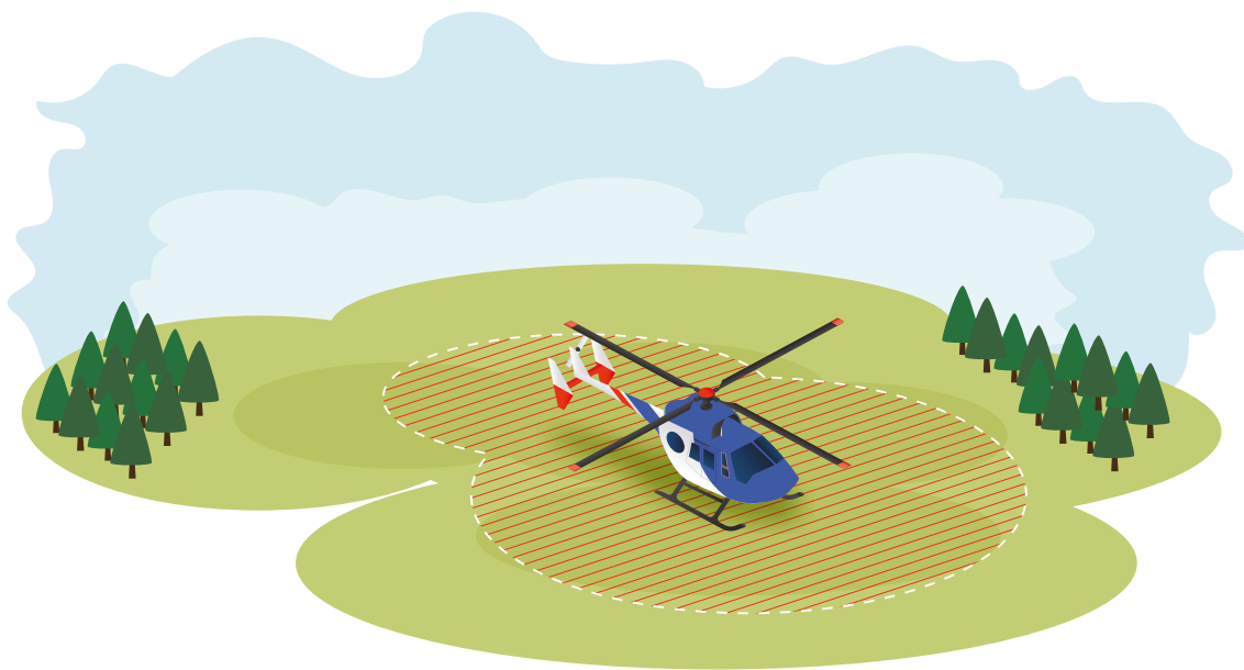
Mynd 13.4 Hættusvæðið nær 5 m út fyrir ytri enda þyrilblaða. Mynd BB.
